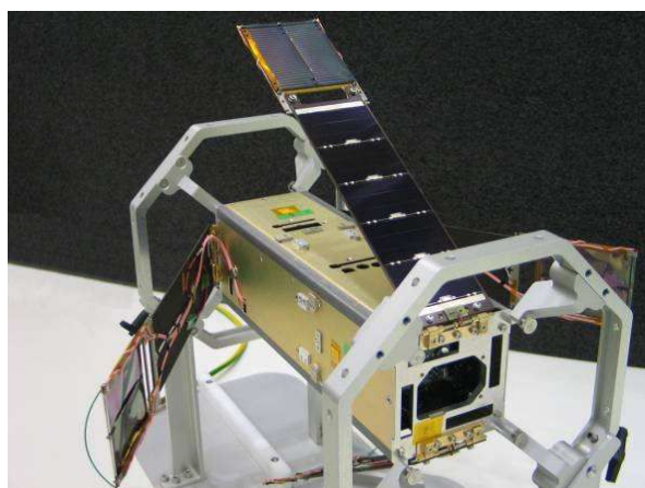
Figura 2.2 - Exemplo de projeto utilizando o padrão CubeSat 3U (Delfi-C3).
