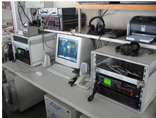
Figura 4.10 - Equipamentos da estação terrena redundante de comando do nanosatélite Delfi-C3 instalada em Eindhoven, Holanda.
